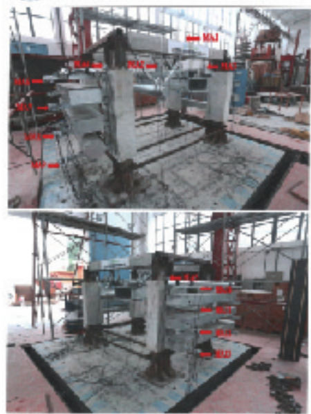
图 2 建筑(核电)用装配式抗震支吊架系统组件、管廊支吊架系统组件、综合成品支吊架系统组件、预埋槽道及配套紧固件、后扩底锚栓抗震试验报告
